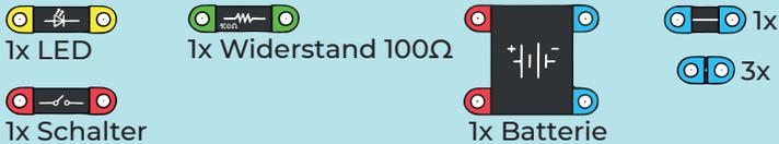
Die Intensität des LED-Lichts wird durch die Höhe des Stroms bestimmt, der durch den Stromkreis fließt. Der in der Schaltung enthaltene Widerstand sperrt den Stromdurchgang, so dass Sie seine Größe einstellen können. Je weniger Widerstand Sie in die Schaltung einbeziehen, desto mehr Strom fließt durch die Schaltung und die LED-Helligkeit wird höher sein.
