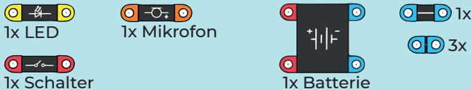
Ein Mikrofon ist ein Bauteil, das Schall in ein elektrisches Signal umwandelt. In der Regel wird der Schall in eine Schwingung der Membran umgewandelt, die als Widerstandsänderung oder Kapazitätsänderung weiter ausgewertet wird. In der Demonstrationsschaltung verändert das Mikrofon den Strom durch die LED, so dass deren Helligkeit auf den auf die Mikrofonmembran treffenden Schall reagiert.
