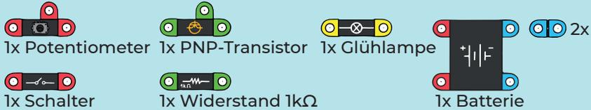
Indem wir einen kleinen Strom in die Basis des Transistors ändern, können wir einen großen Strom durch die Glühlampe steuern, weil das Öffnen und Schließen des Transistors die Spannung über der Glühlampe ändert. Wir verwenden einen PNP-Transistor.
