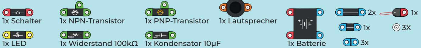
Der Kondensator mit einer Kapazität von 100 nF wird durch einen Kondensator mit einer Kapazität von 10 μF ersetzt. Die Kapazität ist um ein Vielfaches höher, der Dauerton reduziert sich auf ein bloßes Klackern. Die LED blinkt. Die Frequenz des Generators ist unter den Grenzwert gefallen, der hörbar als Dauerton wahrgenommen wird.
