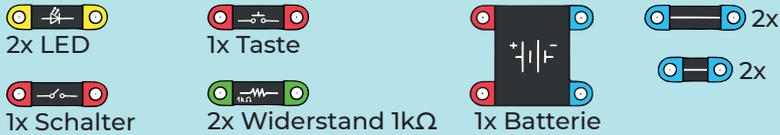
Zu den Grundkomponenten der Schaltung gehören Schalter und Taster, die den Stromfluss steuern. Der Schalter hat zwei stabile Stellungen (Aus und Ein) und nur in der Ein-Stellung fließt Strom durch den Taster.
