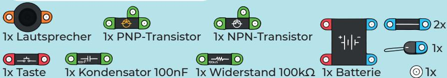
Ein einfacher Summer mit einer Taste zum Trainieren des Morsecodes. Es handelt sich um eine modifizierte S40-Schaltung, bei der der charakteristische Ton für den Empfang von Morsezeichen durch die Wahl der Komponenten erreicht wird.
