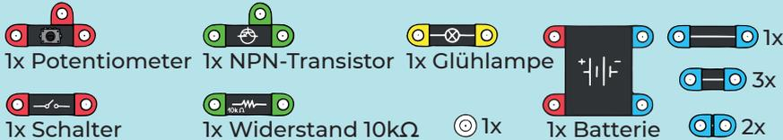
Indem wir einen kleinen Strom in die Basis des Transistors ändern, können wir einen großen Strom durch die Glühbirne steuern, weil das Öffnen und Schließen des Transistors die Spannung über der Glühbirne ändert. Wir verwenden einen NPN-Transistor.
