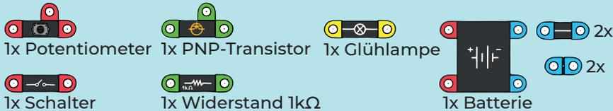
Funktionell die gleiche Schaltung wie der NPN-Emitterfolger, jedoch mit einem Transistor mit entgegengesetzter Leitfähigkeit. Die Richtung des Basisstroms ist umgekehrt, daher ist es notwendig, die Basisschaltung anzupassen.
