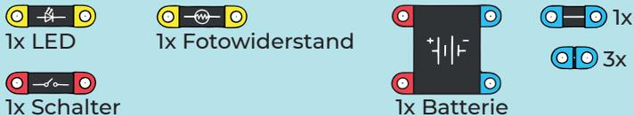
Es gibt elektronische Bauteile, die auf Licht reagieren. Einer davon ist ein Fotowiderstand, dessen Widerstand sich mit der Intensität des einfallenden Lichts ändert. Wenn Sie den Fotowiderstand mit dem Finger abdecken, erhöht sich sein Widerstand. Dies führt zu einer Verringerung der Größe des durch den Stromkreis fließenden Stroms, was zu einer Verringerung der Lichtstärke der LED führt.
