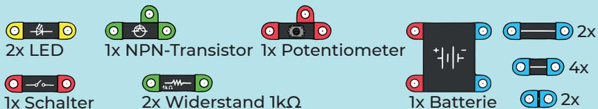
Die Schaltung demonstriert die Fähigkeit des Transistors, einen elektrischen Strom zu verstärken. Das Potentiometer regelt den Strom durch die grüne LED zur Basis des Transistors. Ein kleiner Strom, der gerade ausreicht, um die LED zum Leuchten zu bringen, öffnet den Transistor so weit, dass die Spannung an der LED zum Leuchten gebracht wird.
