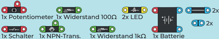
Die Schaltung demonstriert die Fähigkeit des Transistors, einen elektrischen Strom zu verstärken. Das Potentiometer regelt den Strom durch die LED zu Basis des Transistors. Ein kleiner Strom, der kaum ausreicht, um die LED zum Leuchten zu bringen, öffnet den Transistor so weit, dass die Spannung an der LED ausreicht, um sie zum Leuchten zu bringen.
