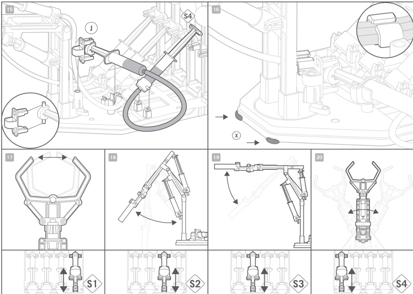
15. Das Spritzenscharnier (J) auf die Spritze ohne eine Nadelkappe klemmen. Dann gleichzeitig das Scharnier auf die Rotationsbasis (S) schieben und das obere Ende des Spritzenkörpers in den Spritzenhalter (K) einsetzen, der wie in [C. 1.] montiert wurde. Zum Schluss die andere Spritze des Sets an den Hebel klemmen (S4).
